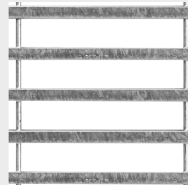
ARRAS D01250 Lichtspalt: 75 % Werkstoff: SN SW O PZ Gewicht: 15,5 kg/m 2 Spaltweite: 25 mm System: H P
