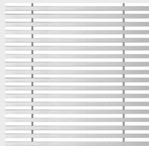
FOBOS Z09040 Lichtspalt: 44,4 % Werkstoff: SN Gewicht: 18,0 kg/m 2 Spaltweite: 4 mm System: H P
